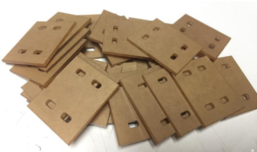
ภาพที่ 9 ฐานยึดที่ได้จากการใช้เครื่องเลเซอร์ตัดเตอร์ตัด
